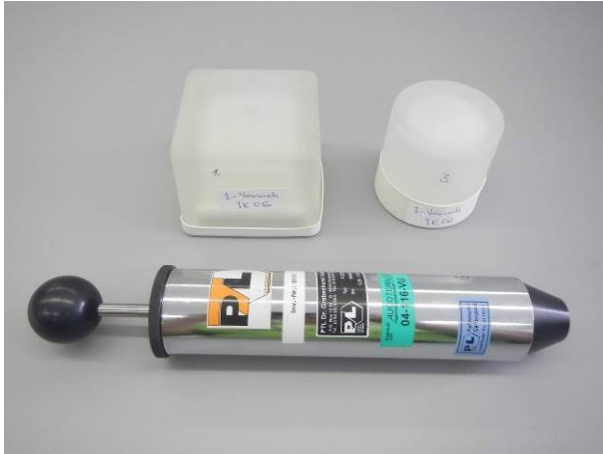
Bild 1 LED Pflastersteinen, Prüflinge Nr.2 und Nr.4 mit Federhammer 0,5 kg | 2 Joule vor der Schlagprüfung IK07
