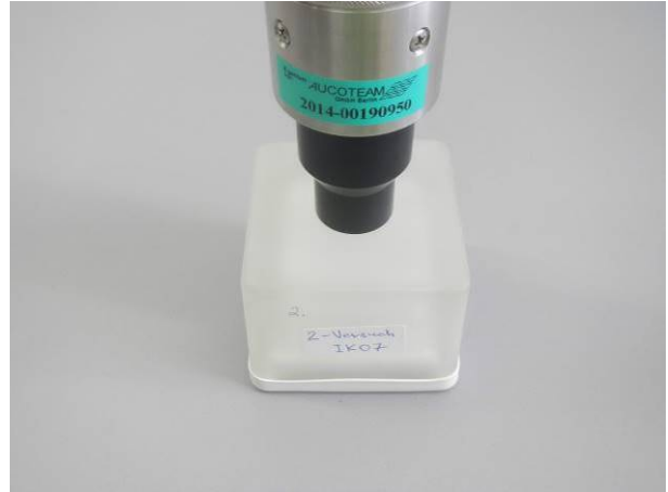
Bild 2 Prüfling Nr.2 mit Federhammer am Prüfbereich bei der Schlagprüfung IK07 (Schlag S6)
